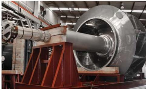
mediante el maquinado de rodetes en nuestro torno vertical con capacidad de 157 pulgadas de diámetro y manejo de peso hasta 70 mil libras, con ensambles interferidos el cuñero es una geometría crítica la cual aseguramos por medio de un equipo CNC.
